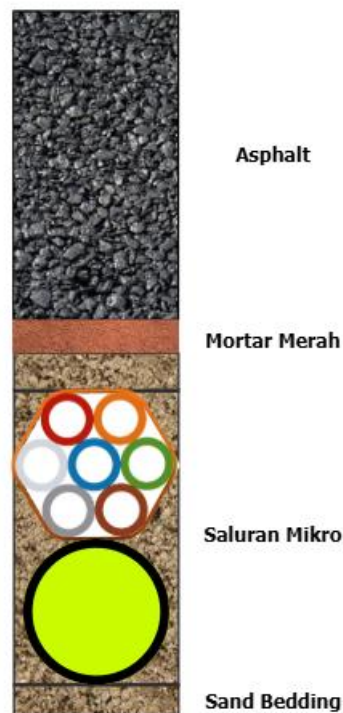
Gambar Rajah 15. Ilustrasi gabungan saluran 40 mm Smooth Wall dan 7-way 14/10 Microduct
